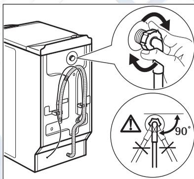
6. Подсоедините наливной шланг обратно. Во избежание утечек воды проверьте герметичность всех гидравлических соединений.
