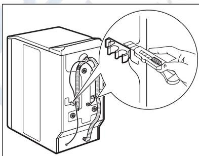
12. Для установки прибора на одном уровне с находящимися рядом предметами мебели отрежьте эти пластиковые элементы.
