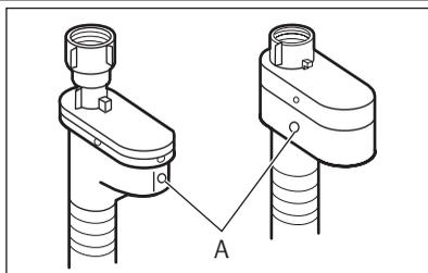
Наливной шланг оснащен устройством для защиты от протечек воды. Это устройство предотвращает протечки, которые могут иметь место по причине естественного старения шланга. О возникновении такой неисправности предупреждает появление красного сектора в окне "А". В подобном случае закройте водопроводный вентиль и обратитесь в сервисный центр для замены шланга.
