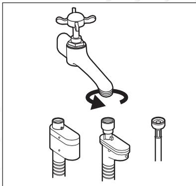
2. Присоедините наливной шланг к водопроводному крану холодной воды с резьбой 3/4 дюйма.
