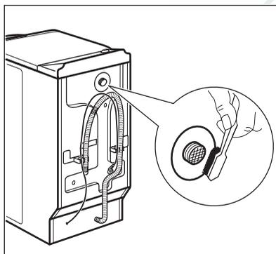
4. Снимите наливной шланг, подключенный к прибору сзади.
