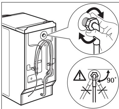
1. Подсоедините шланг к прибору. Ослабьте зажимную гайку и расположите его нужным образом.
